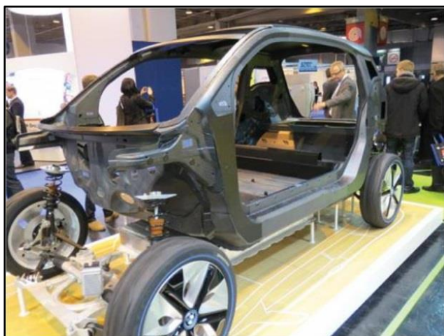
HP-RTM 成形による BMWi3 のフレーム
